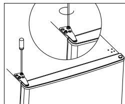
12. Τοποθετήστε το επάνω κάλυμμα και στερεώστε το με 2 βίδες στο τίσω μέρος.
