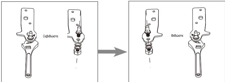
10. Επαναποθετήστε τον βραχίονα τοποθετώντας τον πείρο του κάτω μεντεσέ. Αντικαταστήστε και τα δύο ρυθμιζόμενα πόδια.
