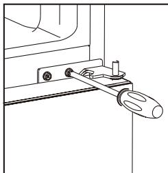
3. Τοποθετήστε το ψυγείο με την πίσω πλευρά στο δάπεδο, αφαιρέστε τα ρυθμιζόμενα πόδια όπως απεικονίζεται ακολουθώς, στη συνέχεια ξεβιδώστε τον κάτω μεντεσέ με το στραυροκατσάβιδο.
